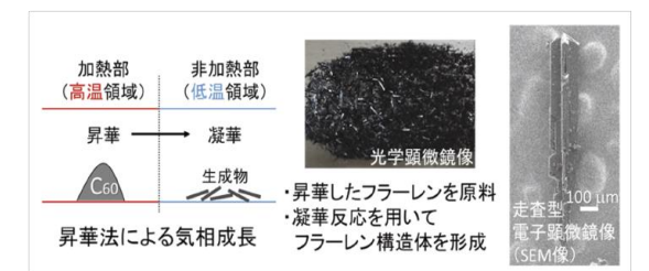
気相成長によるフラーレン構造体の大量合成技術
