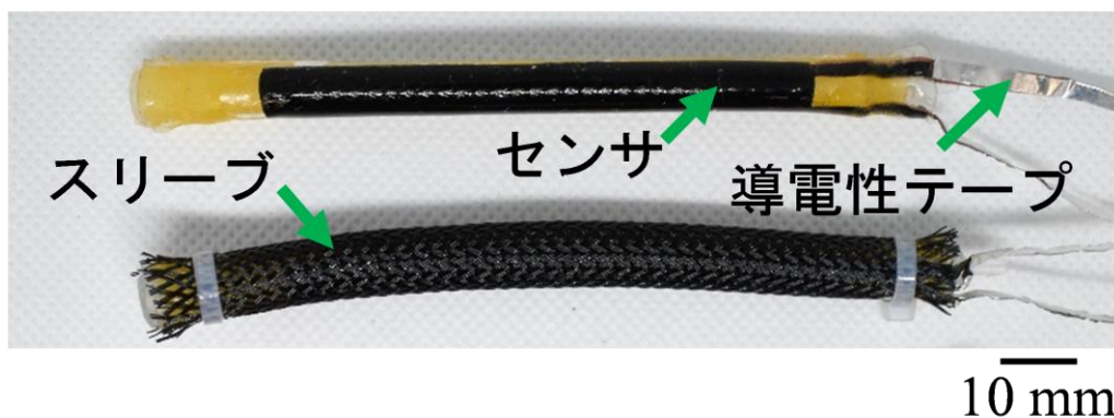
図1 製作したセンサ付き人工筋肉の外観（上）スリーブなし（下）スリーブあり
