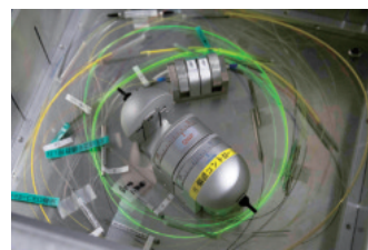
特殊な光ファイバで増幅される光コムの光源。様々なものの形や距離、状態などを極めて精密に測ることができます
