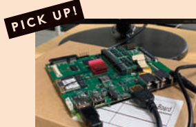
現在実験を行っているマイコンボード。このボード上でプログラムを動かして、刺さっているメモリに故障が起きないかを確認する
