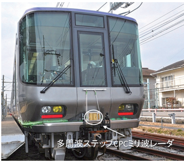
多周波ステップCPCミリ波レーダ 鉄道安全監視システム
