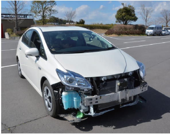
レーダ計測信号からアクセル・ブレーキ・ハンドルを制御可能な衝突回避・自動運転試験車両
